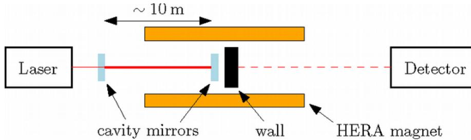
$P(532\text{nm}) \sim 4\text{ W}$   $L \sim 4,5\text{ m}$
